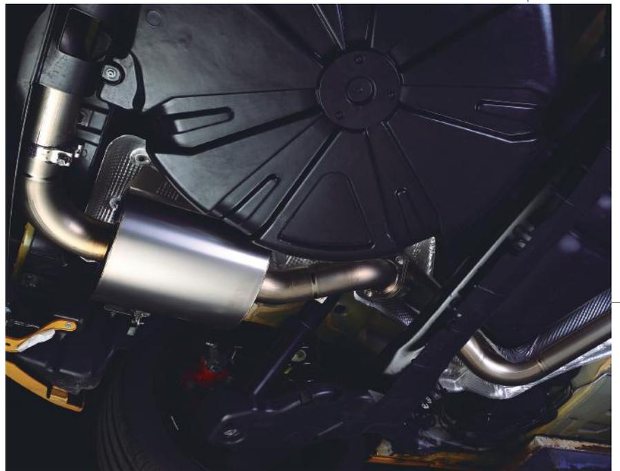
う。メガースR.S.の場合、ブースト圧はノーマルで1.3ぐらいなのだが、このマフラーなら1.5ぐらいまで対応するそう。素材はチタンを使っているのが超軽量。取付、取外しに関しては分割ができるので、作業効率もいい。振動に対しては、触媒の後のパイプを蛇腹にし、吸収できるようにしているとのことだ。現段階ではプロトタイプであるが、このまま製品化する予定だそう。早速ダイナパックで測ってみたら、パワーは6PSアップ。次は吸気側マッピングの書き換えで更なるパワーアップを狙う。ちなみにトロフィもダイナパックで計測したら、驚きの結果に!
