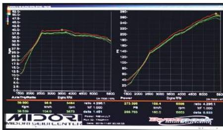
赤がトロフィ、緑の破線がノーマル、実線が緑号です。パワー/トルクとも、トロフィが少し上回っています。緑号はマフラーで6PSアップ。
