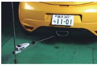
音量もしっかりと測っておかなければなりません。実際の音量はアイドリング時62db、4000rpm時74dbと、音質でははっきり違うのに音量は同じ。さすが!
